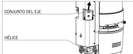
La limpieza de la hélice debe ser efectuada únicamente por personal técnico cualificado, **después de haber desconectado el aparato de la red de alimentación**, conforme al procedimiento siguiente:
