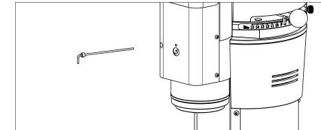
La limpieza del conducto de salida del café debe realizarse introduciendo suavemente la herramienta 5,372.5 en el orificio indicado prestando atención a como se mueve.
