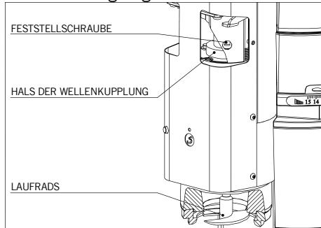
Man kann die Dosiermenge durch Erhöhen oder Verringern der Höhe des Laufrads variieren; gehen Sie wie folgt:
