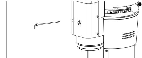
Le nettoyage de la descente de sortie de café doit être effectuée par l'insertion (délicatement) l'outil 5.372.5 dans l'orifice indiqué (attention lors du déplacement de l'outil).
