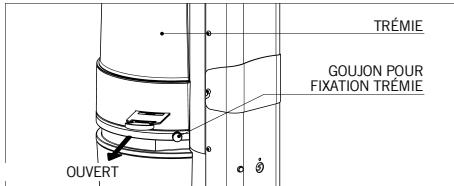
S'assurer que le récipient à café est correctement positionné sur l'appareil et fixé à la carrosserie avec le goujons. Fermer le volet et remplir le récipient de café en grains. Ouvrir le volet de façon à permettre l'introduction du café dans le système de mouture.
