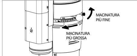
Per macinare il caffè più o meno fine si deve agire sulla leva di regolazione macinatura. Per aumentare la grossezza del macinato è necessario ruotare la leva in senso orario; per diminuirla è necessario ruotare la leva in senso antiorario. La leva rimane nella posizione fissata senza necessità di alcun arresto. La regolazione va effettuata con motore avviato e possibilmente senza caffè tra le macine. Macinare piccoli quantitativi di caffè per la ricerca della granulometria ottimale.
