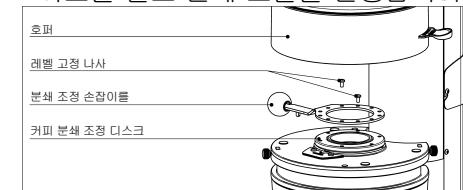
커피 그라인더 도저 과 전자 커피 그라인더 도저, 커피가 에스프레소 커피 기계에서 너무 빨리 빠져 나오는 경우 커피가 너무 거칠게 분쇄된 것을 뜻합니다. 반대로 너무 느리게 빠져 나오는 경우 커피가 너무 미세하게 분쇄된 것입니다. 그럼에도 불구하고 분량의 중량, 압축, 에스프레소 기계 설정 및 필터 청소 등과 같이 올바른 공급에 영향을 미칠 수 있는 조건이 많다는 것을 명심하십시오.
