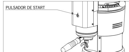
Para dar corriente al aparato, gire la rueda del interruptor hasta la posición I. Insertar el portafiltro directamente en el aparato (**ejercitar solo un esfuerzo ligero; si el aparato se mueve sobre la superficie donde ha sido colocado, entonces se está realizando una fuerza excesiva**).
