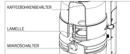
Das Schutzsystem gegen ungewollten Kontakt mit den drehenden Teilen der Mahleinheit besteht aus einem Mikroschalter, der sich unter der Gehäuseabdeckung befindet und die Stromversor-
