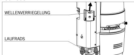
Die Reinigung der Laufrads darf ausschließlich von technisch qualifiziertem Personal durchgeführt werden. **Dafür ist die Stromversorgung zum Gerät zu unterbrechen** und nach folgender Anleitung vorzugehen:
