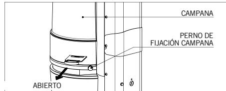
Verifique que la campana está colocada correctamente sobre el aparato y fijada en la carcasa por medio dos pernos correspondiente.
