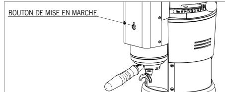
Pour mettre l'appareil sous tension, placer l'interrupteur sur la position I. Enclencher le porte-filtre directement sur l'appareil (**exercer seulement une légère torsion; si le moulin à café glisse sur la surface du comptoir, c'est que vous forcez trop**).
