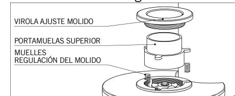
Controlar la presencia en su lugar de los muelas de regulación molido. Después de haber vuelto a colocar el portamuelas superior en su alojamiento, lubricar con grasa adecuada para el contacto con alimentos el anillo de regulación y el rellano de soporte que entra en contacto con el portamuelas superior.
