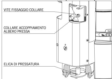
E' possibile cambiare la quantità del dosaggio alzando o abbassando l'altezza dell'elica di pressatura; procedere nel seguente modo:
