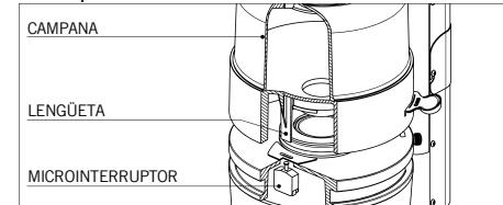
Para la colocación correcta de la campana, ésta se debe fijar en la carcasa mediante los pernos correspondiente.
