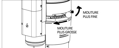
Le réglage de la mouture (plus ou moins fine) s'effectue par l'intermédiaire de la manette de réglage. Pour diminuer la finesse de la mouture, la manette doit être déplacée dans le sens des aiguilles d'une montre; pour augmenter la finesse de la mouture elle doit être déplacée dans le sens contraire des aiguilles d'une montre.
