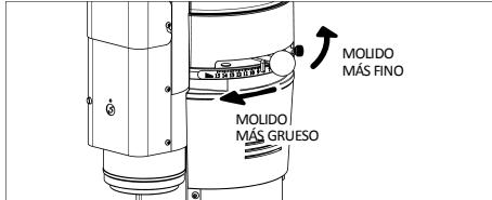
Para moler café más o menos fino, hay que regular mediante la palanca de ajuste molido. Para que el producto molido sea un poco más grueso gire la palanca hacia la derecha; si en cambio desea que sea más fino, gire la palanca hacia la izquierda.
