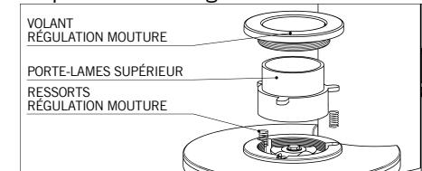
Vérifier que les ressorts de régulation sont à leur place. Après avoir remis en place le porte-lames supérieur dans son logement, graisser avec de la graisse pour le contact alimentaire les filets du volant de régulation mouture et son plan dessous qui est en contact avec le porte-lames supérieur.
